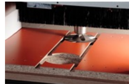
ラメロー加工 ラメローの木口加工がヴァークュームカップを使用せずに加工可能。5軸制御ヘッドのためラメローの角度加工も自由自在
