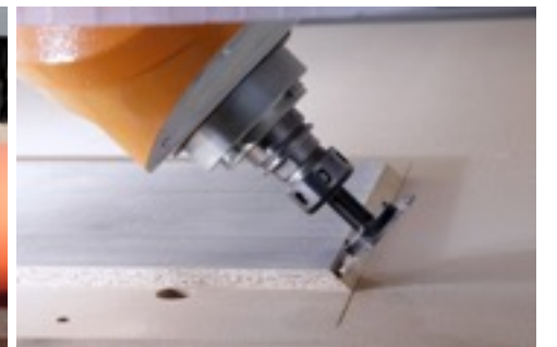
ラメロー加工 ラメローの木口加工がヴァークュームカップを使用せずに加工可能。5軸制御ヘッドのためラメローの角度加工も自由自在
