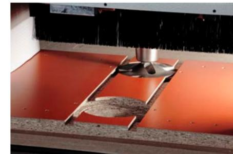
ラメロー加工 ラメローの木口加工がヴァークュームカップを使用せずに加工可能。5軸制御ヘッドのためラメローの角度加工も自由自在
