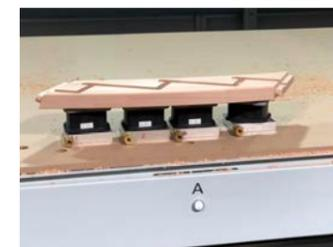
■ MDFで設置された捨て材上に直接ヴァークュームパッドを設置する
