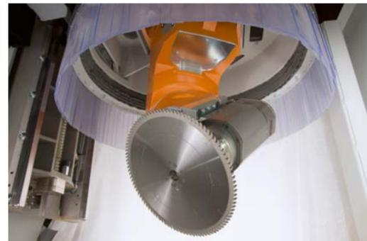
■ 300 mmφまでのノコの装着可能（オプションのノコ専用のツールチェンジ装置の場合は350 mmφまで
