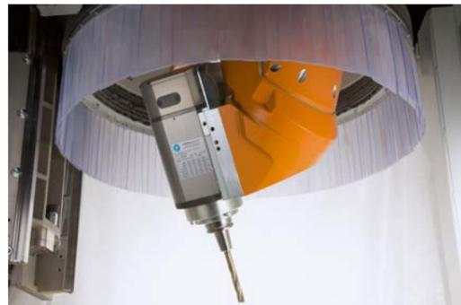
■ 重切削下でもヘッドの長寿命化を実現する水冷ヘッド。速さと柔軟性のための1000 ~ 24000 rpmの無段
