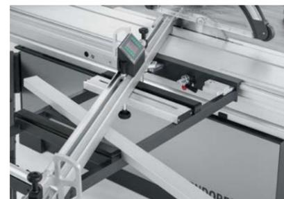
●DIGIT L デジタル表示付き クロスカット・マイターフェンス 最大設定寸法3200mm
