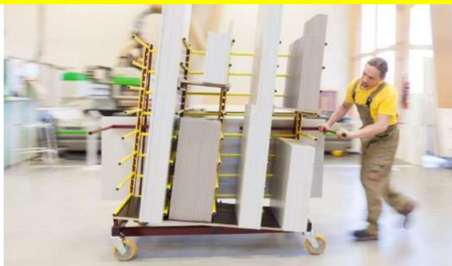
●ラックは後側にも傾きが取られていますので、高速移動時にも手前に倒れません。高速で移動が可能。
