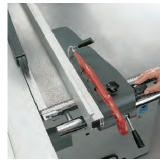
微調整ツマミ付きリップフェンス 最大設定寸法1000mm
