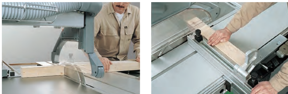
長い材料の定寸カットはリップフェンスを利用すれば簡単で効率的です。フェンスをチップソー手前にセットすることで切断された材料の挟み込みがなく繰り返し作業が可能で簡単に材料を同寸法に切断をすることができます。短くなった材料はクロスカットフェンスを利用します。
