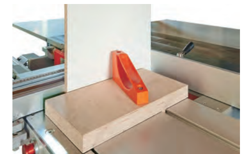
材料押し治具を利用してパネルのコーナーカット
