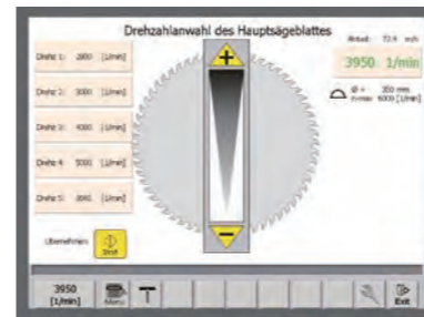
VARIO Drive 主軸インバーター変速 出力5.5kw(7.5hp) 2000~6000rpm ※写真はElmoDriveの画面
