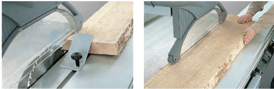
クランプシューで材料先端を固定し切断ラインを決めトリミングカットを行います。スライドソーならではの美しい切断肌の端面切断が可能です。
