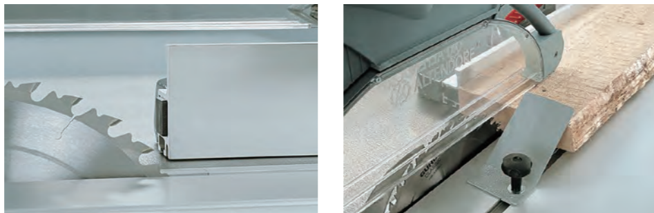
アーテンドルフのリップフェンスは寸法決め幅方向だけでなく前後にスライドする事が可能です。チップソーを超えない位置でフェンスをセットすることで材料の挟み込みによる反発のない安全な幅決め作業が可能です。
