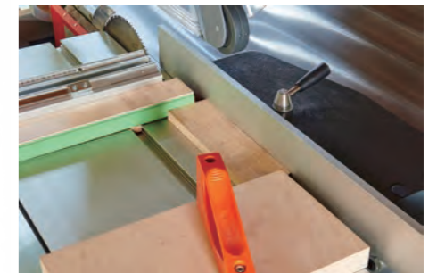
治具セットを利用すれば小さな材料のカットも安全に行えます。
